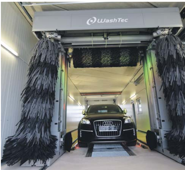
QUALITÄT, WO SIE GEBRAUCHT WIRD: Die moderne Anlage bietet ein variables Konzept an Wasch-, Trocken-, Pflege und Poliermodulen an.
